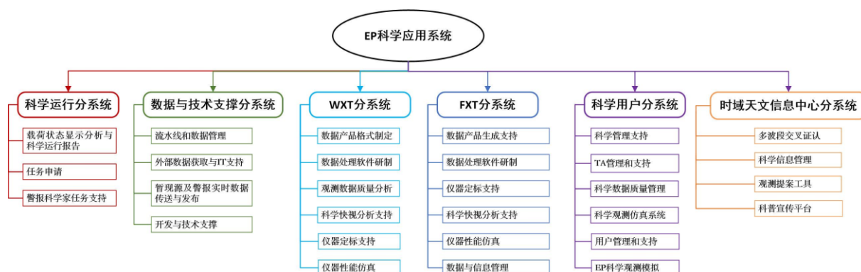
图 4-1 EP 科学应用系统结构和功能总结
