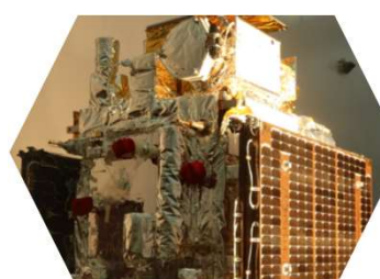
-空间- 46.5mm极紫外 线太阳成像仪 (SUTRI)
