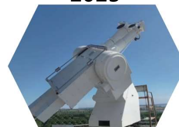
-赣榆- 子午工程Ⅱ期 全日面矢量磁像仪 (SFMM)
